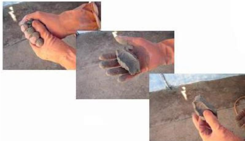
**FIGURA 31** - Teste prático de avaliação de umidade
