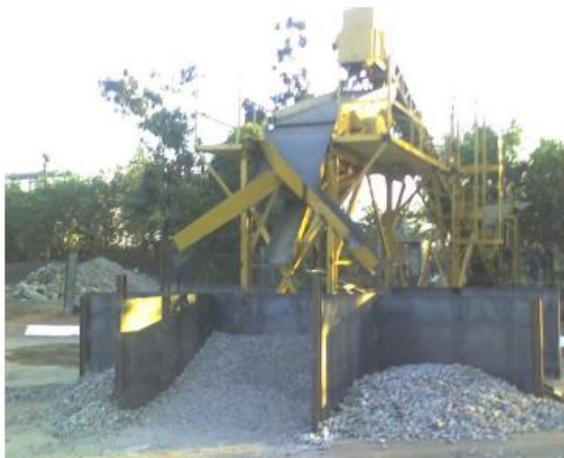
**FIGURA 15** – Sistema de Britagem e classificação em operação
