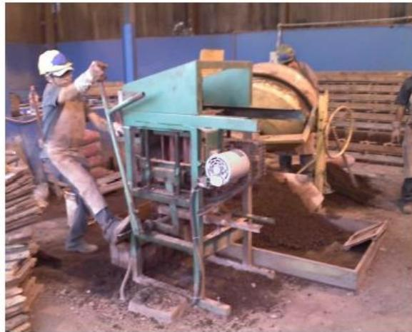
**FIGURA 17** – Máquina manual de produção de blocos intertravado.
