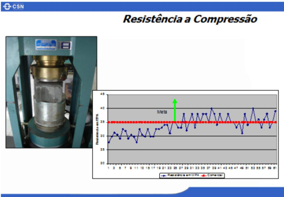
**FIGURA 34-** Evolução da Resistência Mecânica dos Blocos Intertravados.
