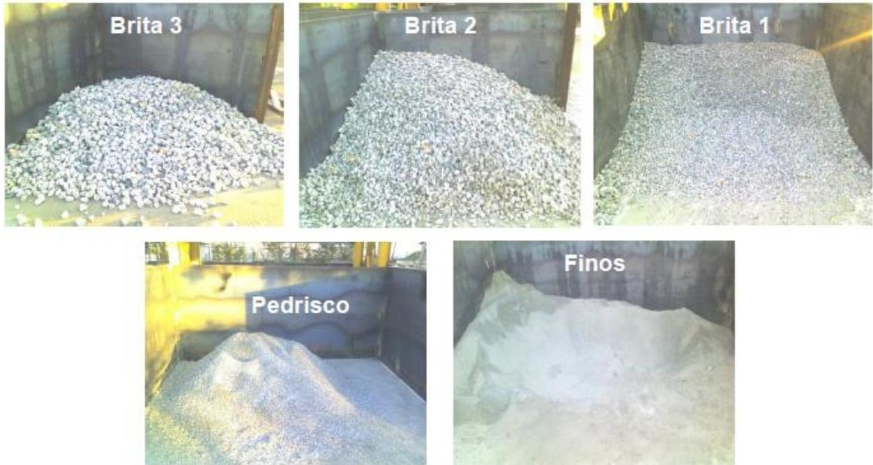
**FIGURA 16** – Agregados gerados
