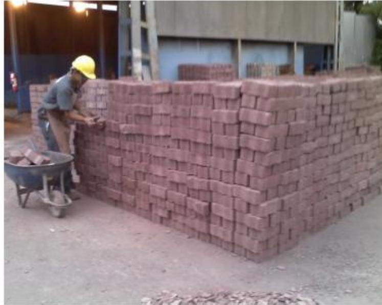
**FIGURA 18** – Empilhamento dos blocos intertravados para a cura.
